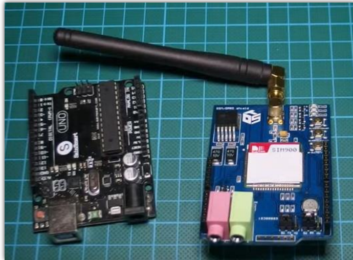
Hình 1.11 - Mạch Shield sim900 (sinh viên thực hiện)
